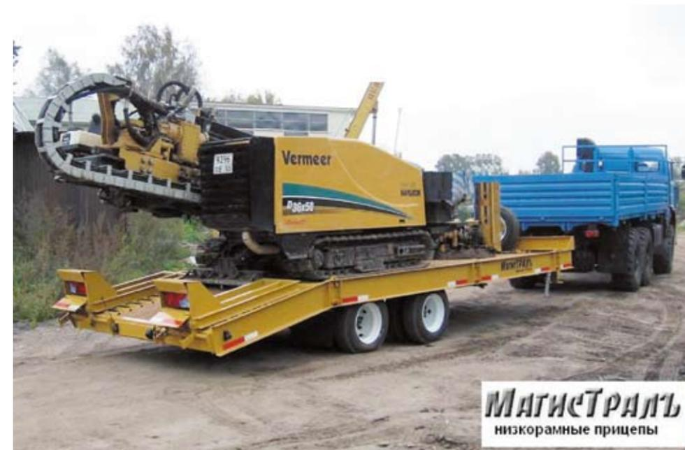
заднюю часть и оси прицепа расположены под задней частью установки. Чтобы проще понять, представляю схему расположения установки ГНБ на стандартном прицепе и на низкорамном прицепе «Магистраль».
